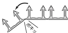
※ご注意:○ウレタン防護カバーは1mごとにカットして、約10cm間隔をあけて取付けます。(カバー間のFケーブルはウレタン面に触れないよう曲げます。)1mカットのカバーをステップルで留めると、入線作業がしやすく、熱もこもりにくくなります。
