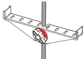
**POINT** 摘みが上イラストと同じかで3分ボルトに取付けできているか一目で確認できる
