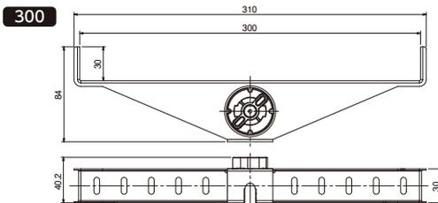
● 材質：樹脂部／硬質塩化ビニル、金属部／亜鉛めっき鋼板
