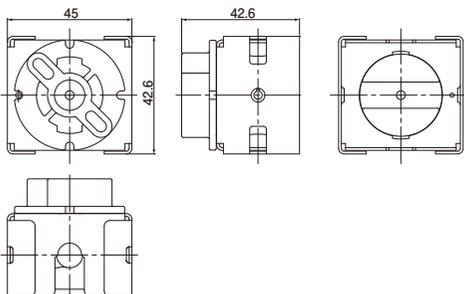
● 材質：樹脂部／硬質塩化ビニル、金属部／亜鉛めっき鋼板
